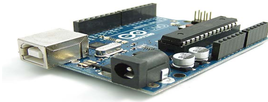
Figura 6. “Arduino” è una piattaforma hardware open source, semplice da usare, in grado di interagire con l'ambiente in cui si trova ricevendo informazioni da una grande varietà di sensori.
