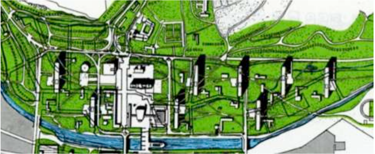
Fig. 20. Nel piano di ricostruzione di Saint Diè ed in quello di La Rochelle (fig. 21), Le Corbusier cercò di mettere in pratica l'ultimo modello da lui elaborato, quella di una città composta di Unità di grandezza conforme, u grande parco verde dove si collocano liberamente le grandi unità residenziali.
