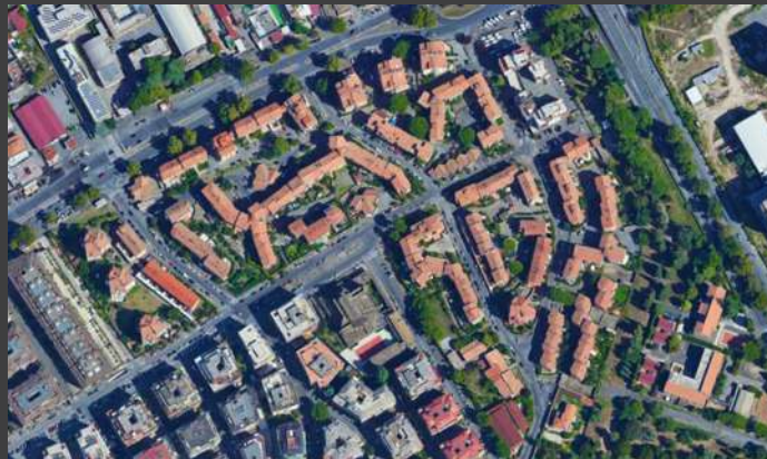
Vista aerea del quartiere Tiburtino di Ludovico Quaroni; si noti l'assenza di una rigida struttura geometrica e l'ampio uso di corti e cortili.
