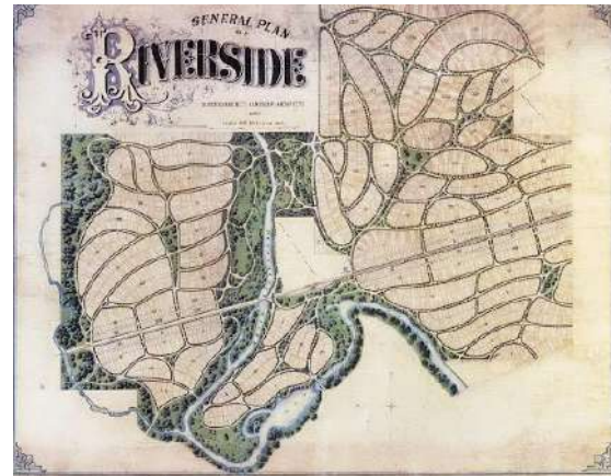
Fig. 4. Planimetrie di due fra i primi Gardens suburbs; a destra Riverside, negli Stati Uniti, su progetto di Olmsted presenta una struttura viaria con percorsi curvilinei di ispirazione naturalistica; a sinistra, Bedford park a Londra presenta una struttura maggiormente ispirata a forme geometriche più tradizionali, anche se la complessiva composizione rifugge le rigidità e le simmetrie degli impianti classici.
