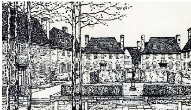
Fig. 8. Tre elementi di base suggeriti da Unwin per la progettazione urbana: il cortile a cul de sac chiuso su tre lati, un cortile attrezzato per attività sportive ed uno spazio comune ottenuto mediante arretramento dei fabbricati.
