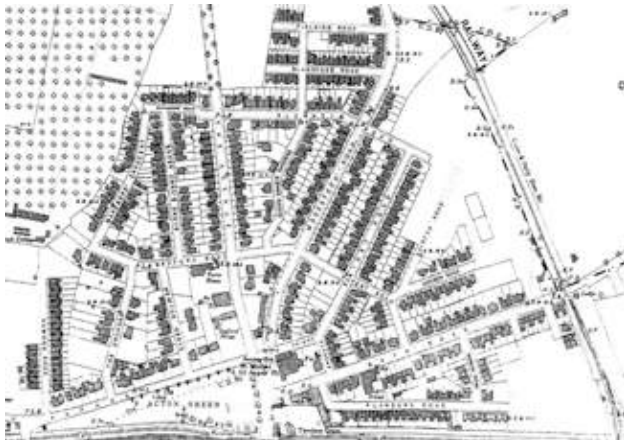
Fig. 4. Planimetrie di due fra i primi Gardens suburbs; a destra Riverside, negli Stati Uniti, su progetto di Olmsted presenta una struttura viaria con percorsi curvilinei di ispirazione naturalistica; a sinistra, Bedford park a Londra presenta una struttura maggiormente ispirata a forme geometriche più tradizionali, anche se la complessiva composizione rifugge le rigidità e le simmetrie degli impianti classici.
