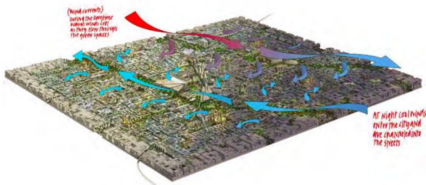
Figura 3 | Studio dei venti dominanti in relazione all'insediamento.
