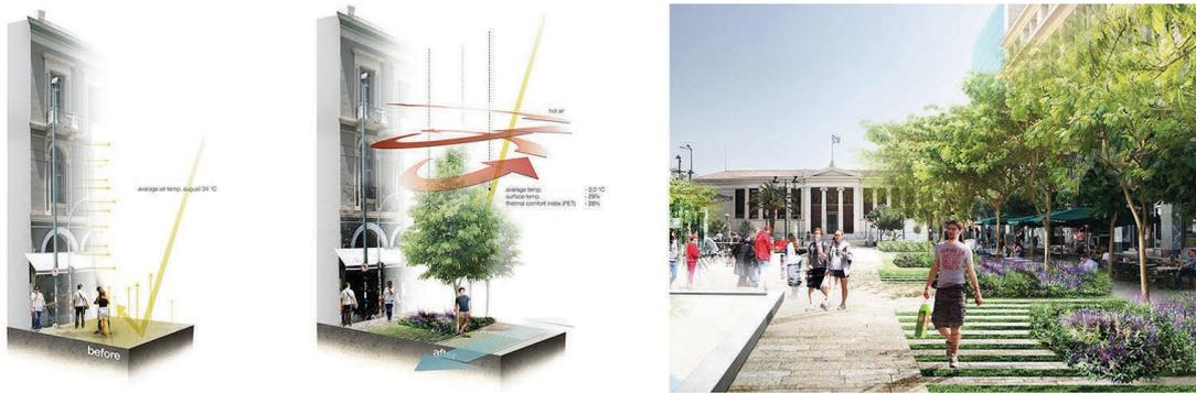
Figura 1 | Caso n.1 - Descrizione del comportamento ambientale prima e dopo l'intervento: abbassamento della temperatura medie dell'aria registrate di  $-3.0^{\circ}\text{C}$  (rispetto a  $34^{\circ}$ ); temperatura superficiale  $-29\%$ , PET  $-28\%$ .
