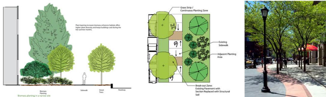
Figura 2 | Caso n.7 - Esempio di linea guida per la realizzazione di marciapiedi a ridotto carico solare.
