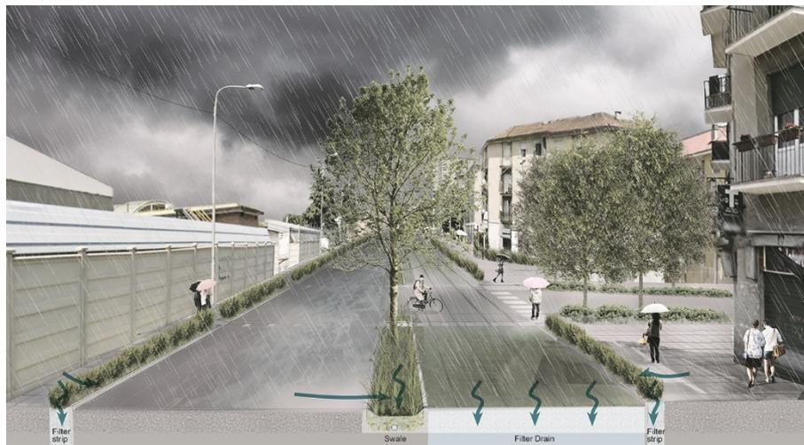
Figura 4 | La raccolta delle acque da dilavamento superficiale e il progetto delle *swales* lungo la viabilità esistente.
