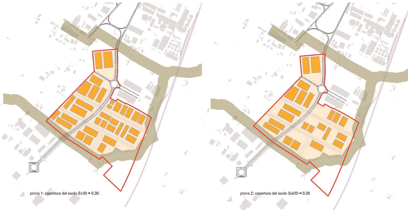
Zipa verde: simulazione sull'area di proprietà del consorzio per valutare la copertura del suolo
