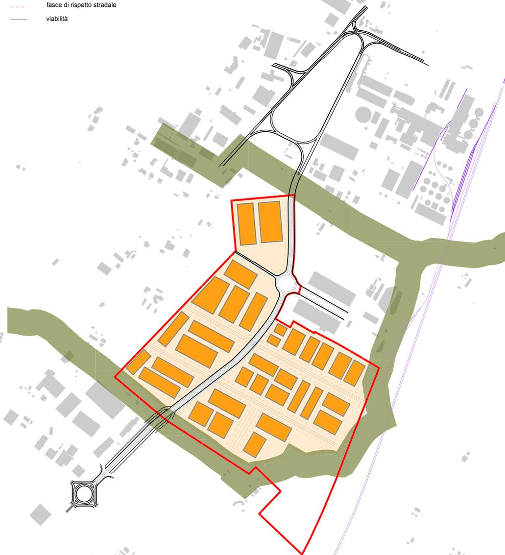
prova 1: copertura del suolo Sc/St = 0,30
