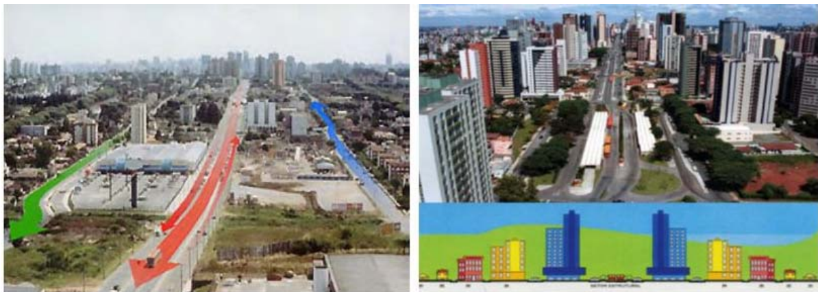
Fig. 1. Curitiba, schema di funzionamento del BRT e struttura del TOD (Fonte http://www.worldstreets.wordpress.com )
